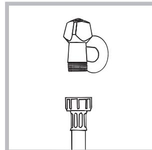
1. Conectați tubul de alimentare, înșurubându-l la un robinet de apă rece cu gura filetată de 3/4 gaz (a se vedea figura).
